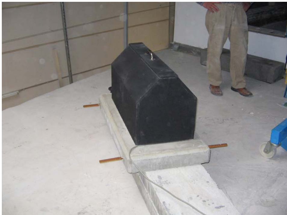
Bild 4: Norm-Hammerwerk auf Prüfanordnung mit Schalldämmhaube
