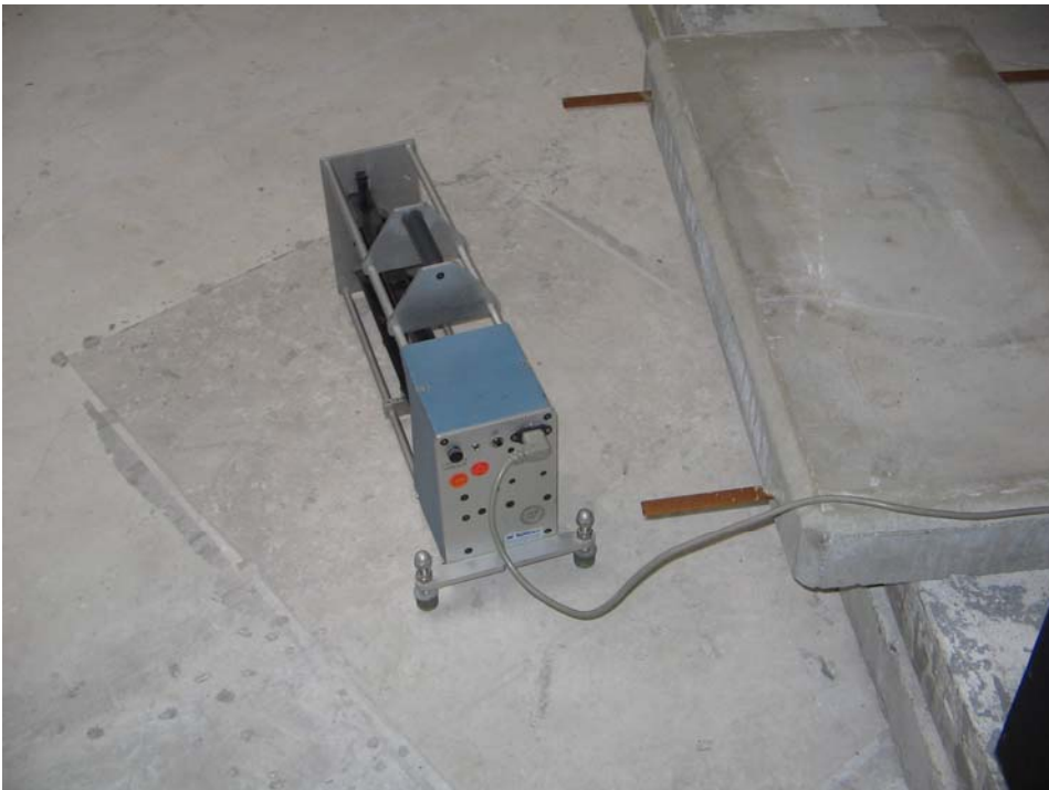
Bild 6: Norm-Hammerwerk auf Rohdecke
