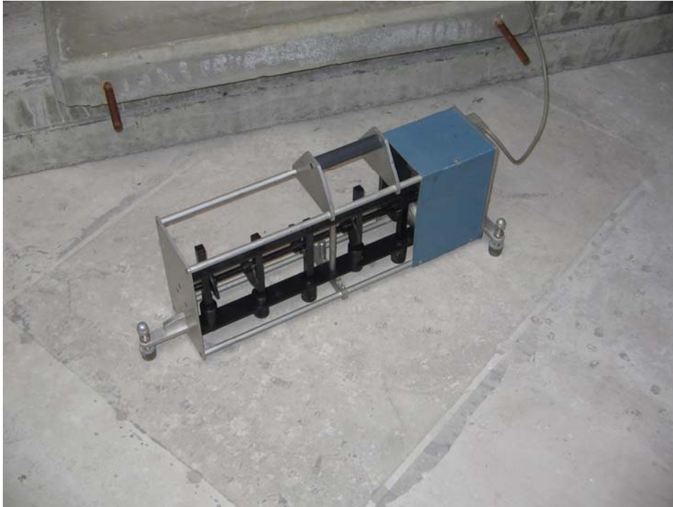
Bild 6: Norm-Hammerwerk auf Rohdecke
