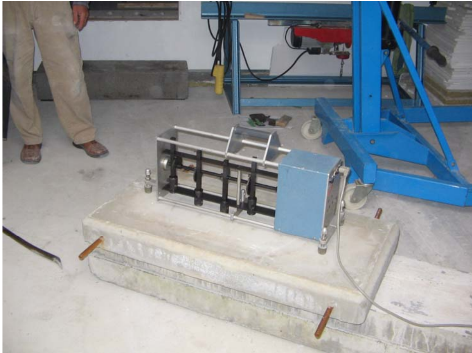
Bild 4: Norm-Hammerwerk auf Prüfanordnung mit Schalldämmhaube
