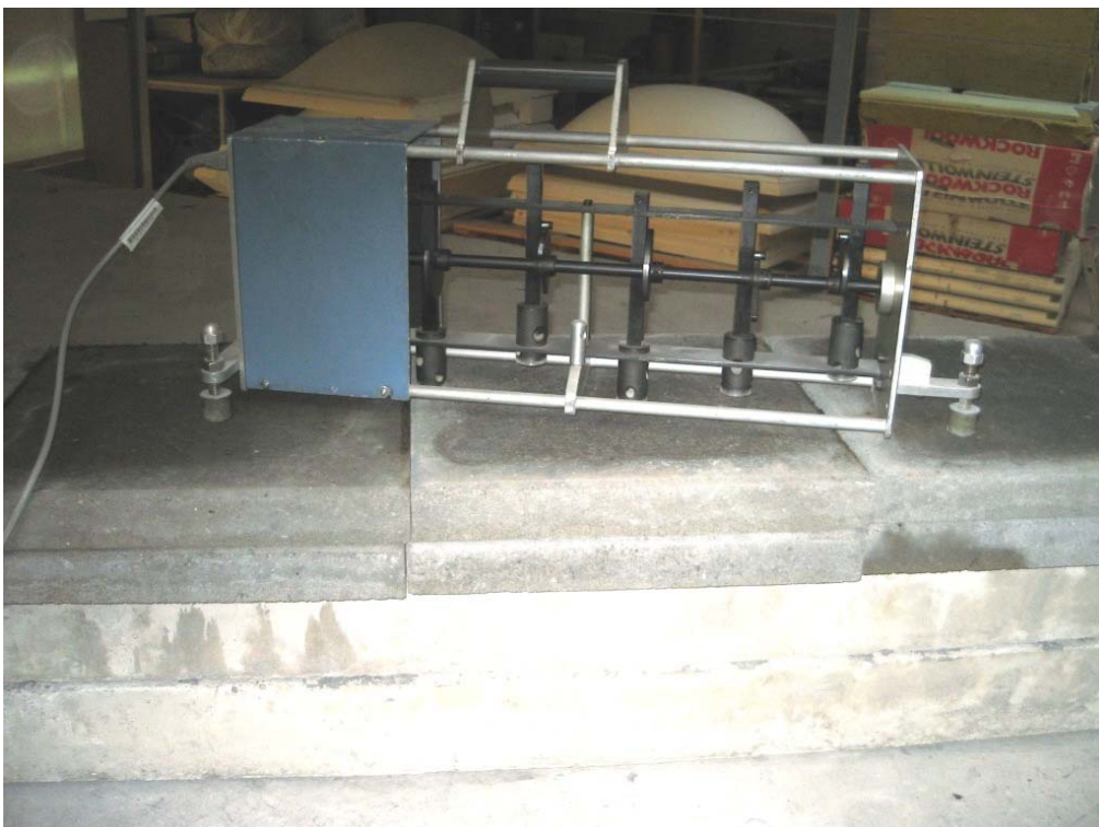
Bild 6: Treppenlager egcoscal T mit Laststufe 900 kg (Messung 3), p = 0,3 \text{ N/mm}^2
