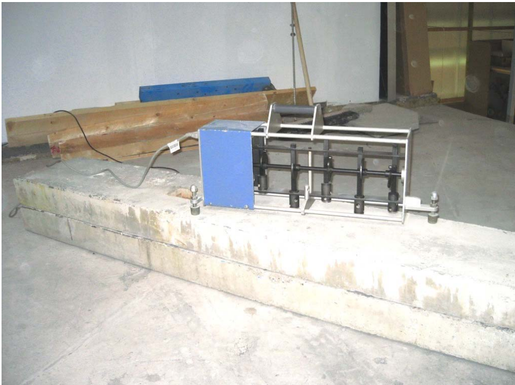
Bild 4: Treppenlager egcoscal T mit Laststufe 600 kg (Messung 2), p = 0,2 \text{ N/mm}^2
