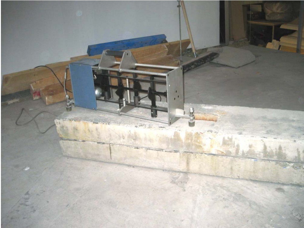
Bild 3: Treppenlager egcoscal T mit Laststufe 600 kg (Messung 2), p = 0,2 \text{ N/mm}^2
