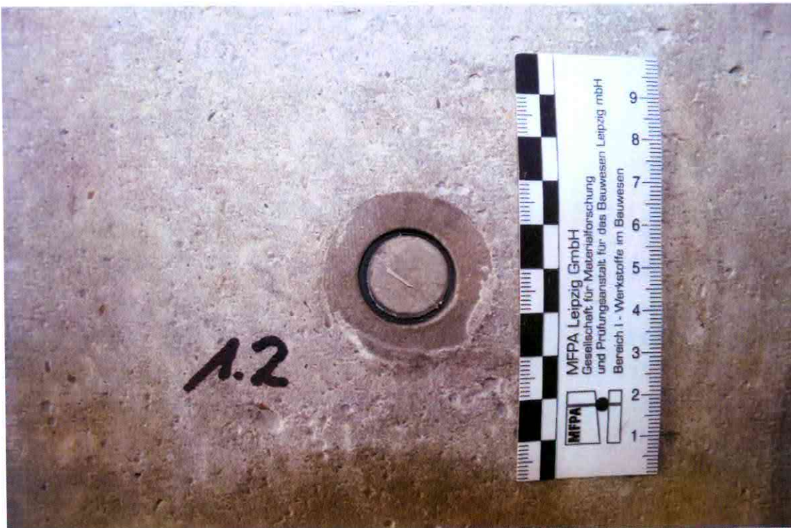
Bild 2: Verschlussstopfen des Probekörper 1.2 nach erfolgter Druckprüfung
