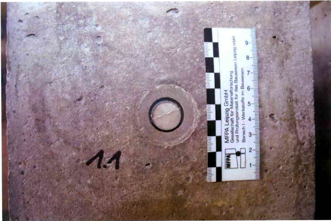
Bild 1: Verschlussstopfen des Probekörper 1.1 nach erfolgter Druckprüfung
